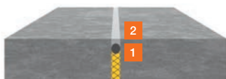
Vertikale/horizontale Fuge nicht befahrbar
