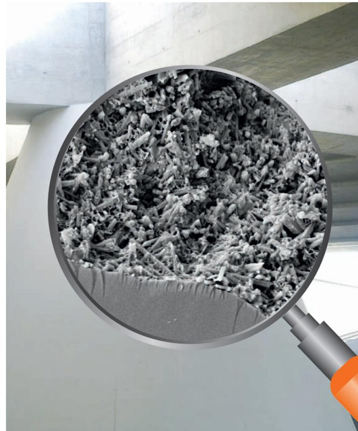
Bei der PCI Nanocret®-Familie wurde die Zementhydratation optimiert. So entsteht auf Nanoebene eine noch bessere Vernadelung, die den Schwind reduziert und die Anhaftung verbessert.
