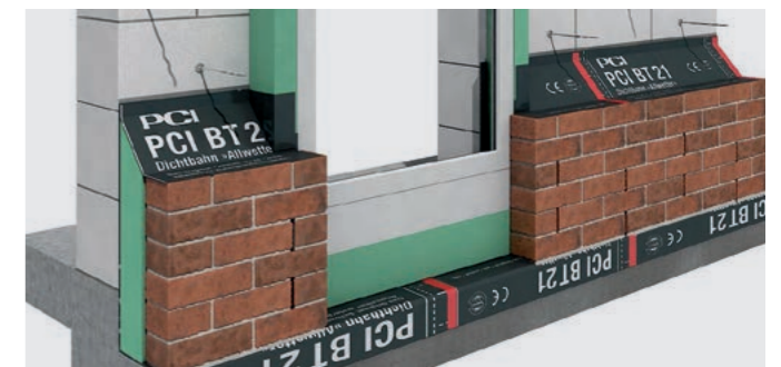
Eingebautes Aufstockelement rückseitig gegen Durchfeuchtung geschützt
