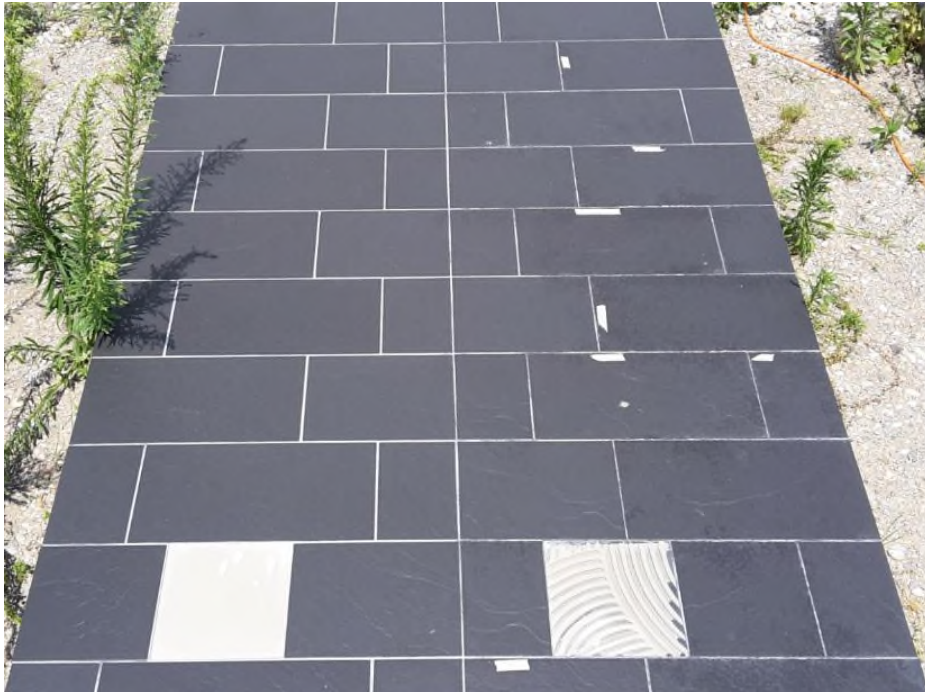
Versuchsreihe mit Klebern: Ausblühen nur bei Hohlräumen
