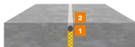
Vertikale/horizontale Fuge nicht befahrbar
