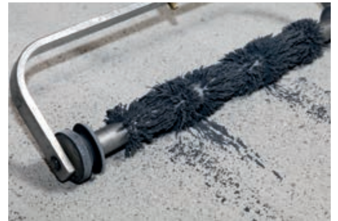
Magnetrolle zum Einsammeln von liegen gebliebenem Strahlgut
