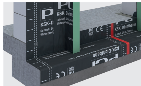
Grundabdichtung mit PCI Pecithene 1000 - bereits abgedichtetes Fensterdämmelement
